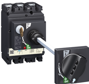
EasyPact CVS con mando rotativo prolongado instalado en la parte posterior de un cuadro, con la opción de cierre con candado y llave.
