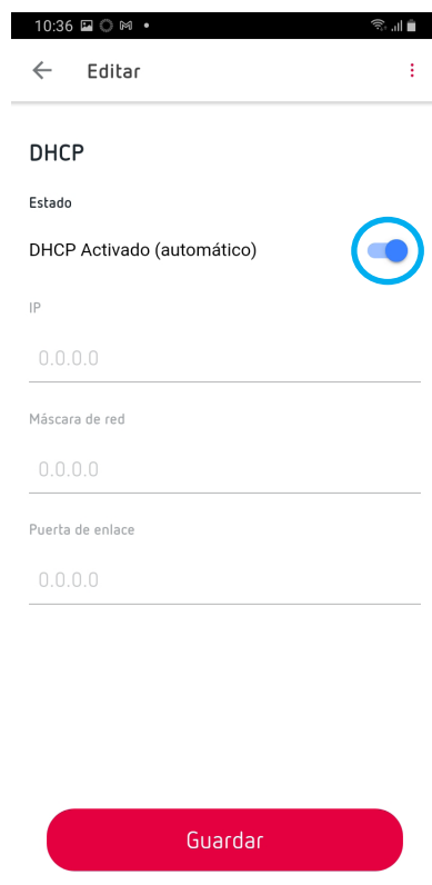
Figura 11: Pantalla Estado Ethernet (DHCP activo).
