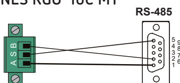
Figura 4: Comunicaciones RS-485 (Modelo RGU-10C MT).
