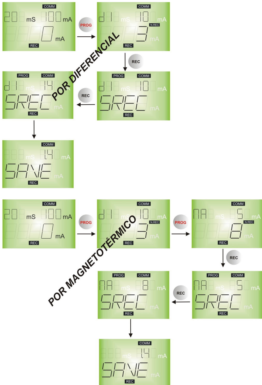
Figura 26:Ajuste diferencial y magnetotérmico.
