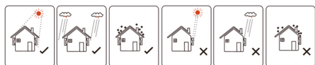
Fig. 17. Emplacements recommandés pour l'installation de l'onduleur.
