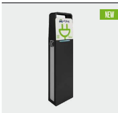
Puntos de recarga para vehículos eléctricos tipo poste con OCPP dotados de protecciones eléctricas según normativa ITC-BT-52: automático + Diferencial Tipo "A" + Protección contra sobretensiones transitorias y permanentes
