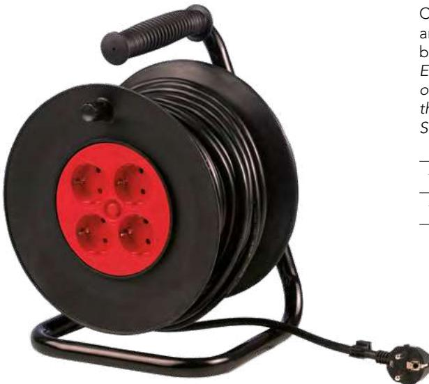
Enrollacables, clavija bipolar SCHUKO con T.T. lateral y central. Tipo (CEE7/7). 4 tomas con T.T. lateral, con obturadores, sin tapa y limitador térmico de seguridad. Rodete con pie soporte. Sección de cable: 3x1,5 mm<sup>2</sup>
