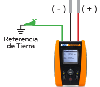
FUNCIÓN MΩ | aislamiento dual Campo FV no conectado a tierra
