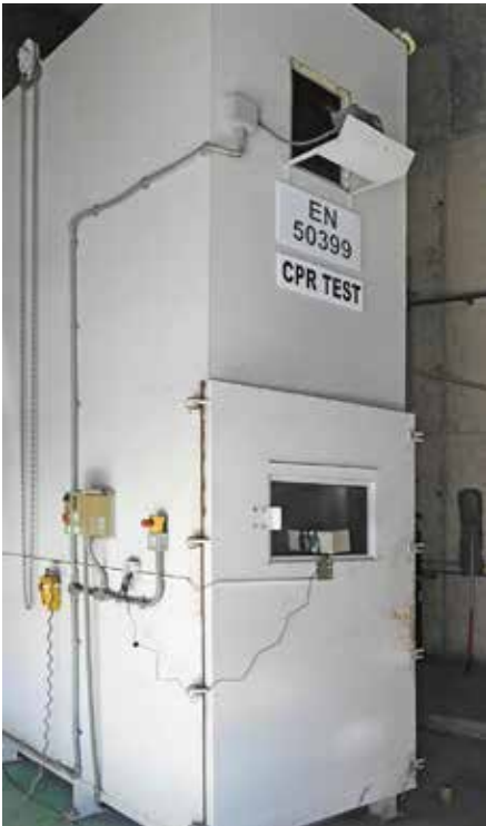
Cámara de ensayos CPR (EN 50399).
