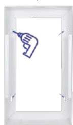
1- Fijar zócalo metálico a la pared
