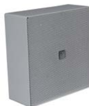
PEM15TF 16 W 100 V Altavoz compacto en acero rígido pintado resistente a los impactos. Montaje mural o en techo Chasis rígido antivibración en aluminio extruido con rejilla en aluminio Antivandálico. Altavoz bicono con membrana siliconada. Ideal para parkings, locales públicos y sonorización de seguridad
