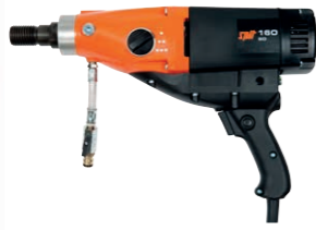
SD 160 6,70 kg - 2000 W 660, 1550 y 3300 rpm 1 1/4", 1/2" SD 250E
