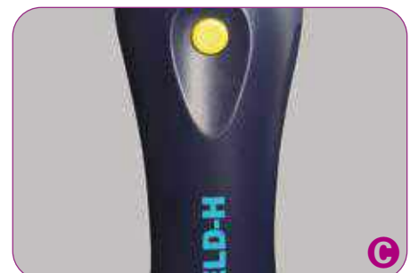
C Si las prestaciones del detector son correctas 5 g/año, el instrumento responderá en pocos segundos.
