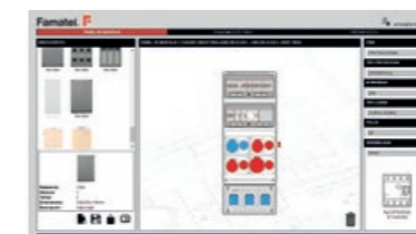
Configuración de cuadro modo libre o según REBT 2002 Free combination of enclosure
