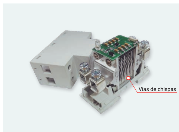
Interior módulo Vigivolt V2T-50/100. Transitoria, Tipo 1+2, 1P+N, 50 kA.
